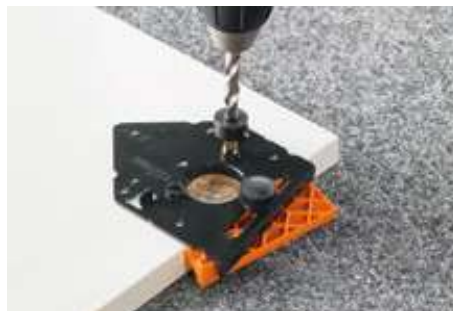
使用 Blum 百隆的铰链钻模，高效钻打 Blum 百隆铰链的安装孔。
