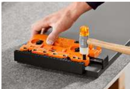
借助通用模具可以精确地标记并预钻固定孔。
