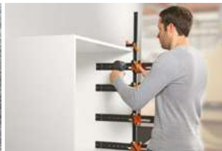
借助定位模具，可以轻松传送导轨的精确固定位置。
