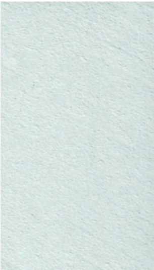
Modern blue NF07-A 配比: 4g F07 /10kg microcement
